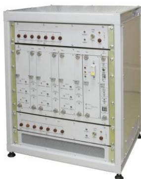
Рис. 9 – Применение модулей, разработанных в ОКР «Мегалит-Б-ВК», при создании ЦЧ СВЭП с магистрально-модульной архитектурой
