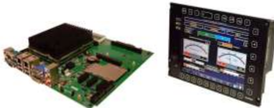
Рисунок 3. СОМ-модуль CPC310 с платой-носителем КИВ1400 и Панельный ПК BC04 отечественной разработки ЗАО «НПФ «Доломант»
