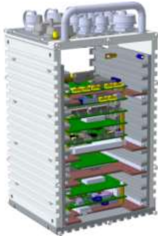
Рисунок 13. Система кондуктивного теплоотвода для стековых модулей
