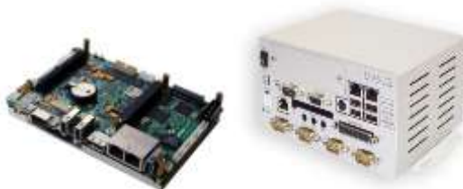
Рисунок 4. Одноплатный компьютер CPB909 и защищенный компьютер MK905 отечественной разработки. ЗАО «НПФ «Доломант»
