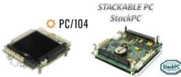
Рисунок 2. Стековые модули форм-фактора PC/104-plus (CPC310) и StackPC (CPC309) отечественной разработки ЗАО «НПФ «Доломант»
